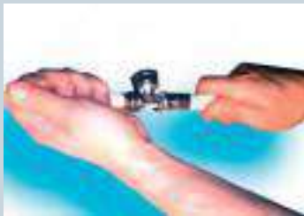
4. Inserción: Introduzca completamente la tubería en el casquillo de acero y en el accesorio. Para comprobar su completa inserción, observe que aparece la tubería en la perforación realizada en el casquillo de acero.
